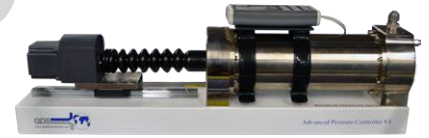
图3 用于非饱和土试验的高级控制器
