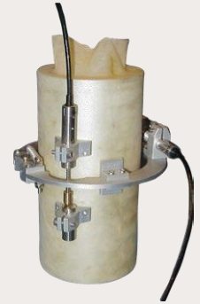
图2 安装于试样上的LVDT传感器
